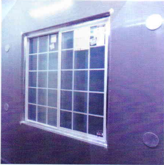
<사진 1> 열관류율 향온측 시험체 모습
